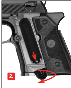
2. Kapsül baskı vidasını tamamen aşağı ininceye kadar çevirin
