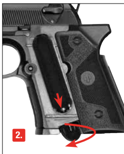
2. Avvitare completamente la vite di pressione della capsula
